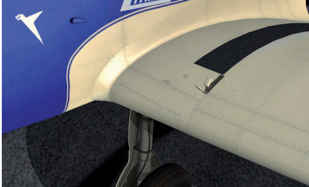
Der „Knickhebel“ am Flügel mit Details des Fahrwerks.
